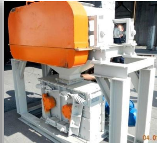
Двухуровневая валковая дробилка 2ВД
